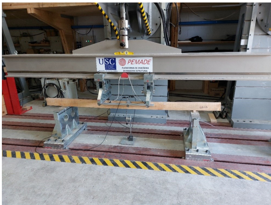
Figura 4. Ensayo de flexión en tabla de Pinus pinaster .
