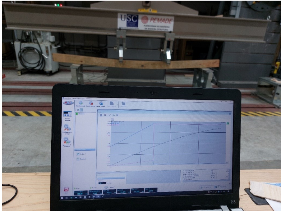
Figura 5. Ejemplo de adquisición de datos durante un ensayo de flexión en tabla de Pinus pinaster.
