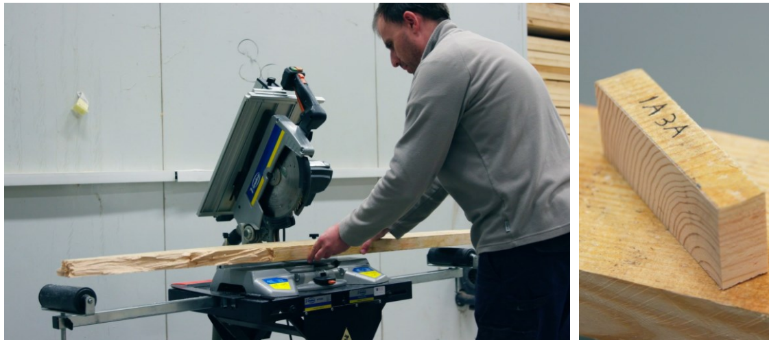
Figura 6. Extracción de rebanadas de las tablas de Pinus pinaster para la determinación de la densidad del material.
