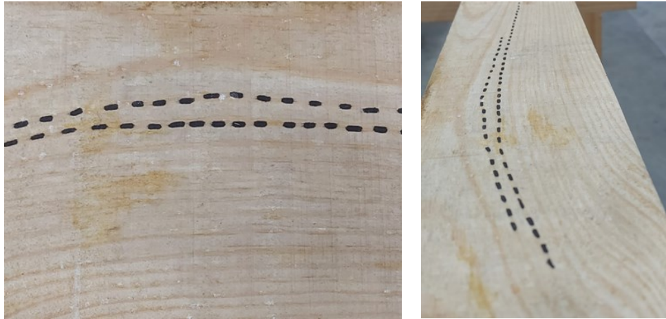
Figura 3. Detalle de desviación de fibra en tabla.
