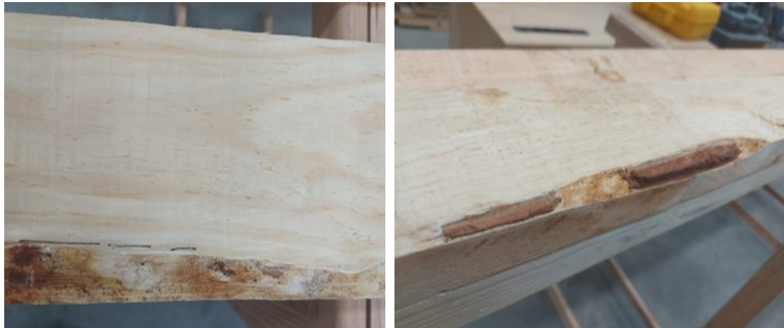
Figura 4. Detalle de la presencia de gemas en tabla.
