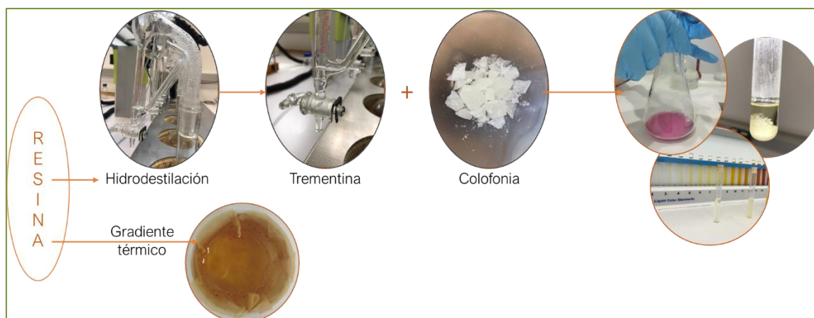
Flujo de análisis de la resina y componentes
