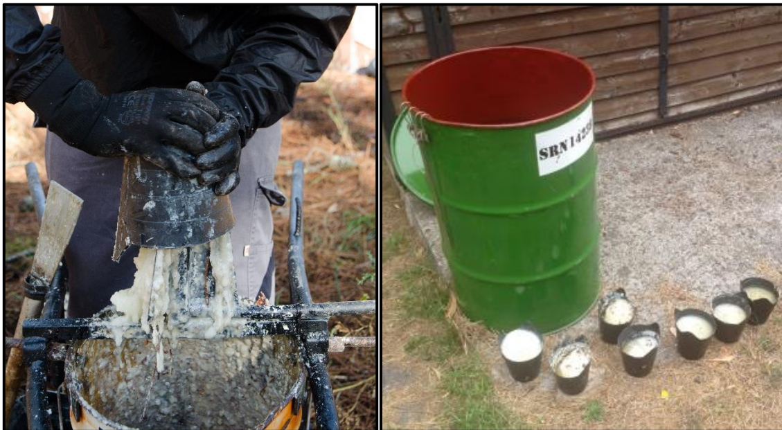
Imagen 10 A la izquierda, detalle del exprimidor de la carretilla y a la derecha, bidón para el almacenamiento de la resina.
