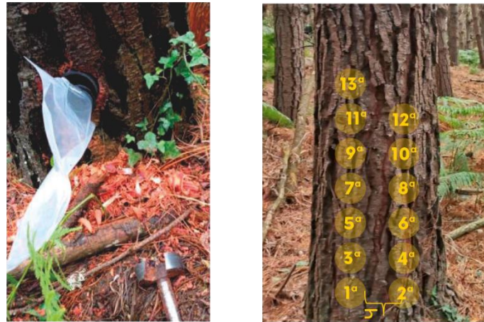
Figura 3. Protocolo de trabajo empleado para el método de entalladura circular mecanizada.
